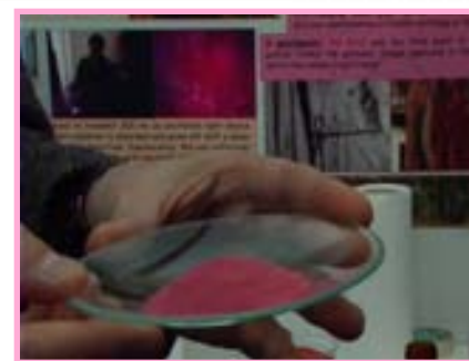
Συλλογή της λάκας αλιζαρίνης μετά την ξήρανση του στερεού υπολείμματος στο διηθητικό χαρτί
