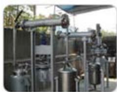
Εικόνα 11. Ένας αντιδραστήρας υπερκρίσιμης εκχύλισης στην Κίνα (αριστερά) και στην Ινδία (δεξιά φωτογραφία)
