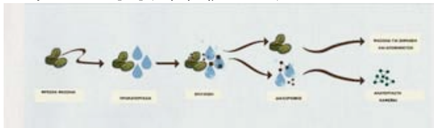
Σχήμα 11. Η διαδικασία της παραγωγής ακατέργαστης καφεΐνης από κόκκους καφέ
