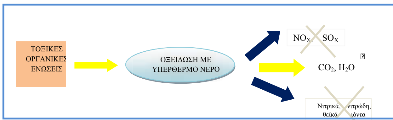
Σχήμα 14. Το αποτέλεσμα της οξείδωσης των τοξικών οργανικών ρύπων σε υπέρθερμο νερό
