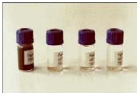
Εικόνα 3 Υγρά απόβλητα πολυμερών κατά την οξείδωση σε υπέρθερμο νερό
