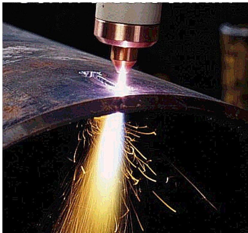
Φωτογραφία 7. Ηλεκτρόδιο κοπής με πλάσμα σε λειτουργία
