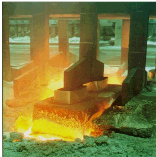
Φωτογραφία 3. Άνοδος από γραφίτη εν λειτουργία κατά την ηλεκτρολυτική παραγωγή του αργιλίου
