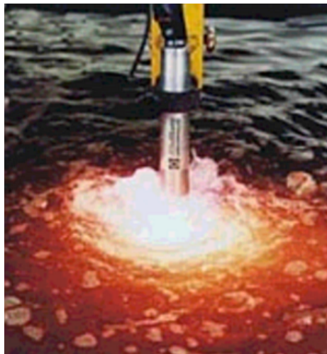
Φωτογραφία 9. Ηλεκτρόδιο κοπής πλάσματος σε υποθαλάσσια λειτουργία
