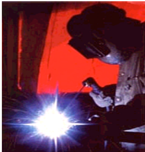
Φωτογραφία 8. Ηλεκτρόδιο κοπής βολφραμίου σε λειτουργία
