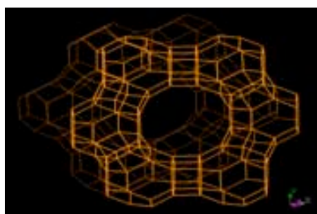
Σχήμα 14. Δομή του ζεολίθου \text{Na}_{12}[(\text{Al})_{12}(\text{SiO}_2)_{12}]
